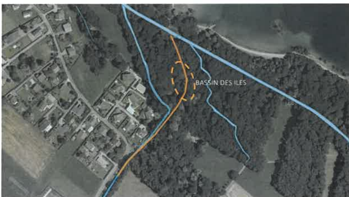
Tronçons de cours d'eau concernés - la cartographie hydrographique du cadastre est erronée
